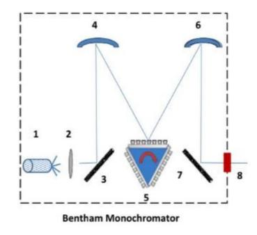
(1) Lampe multispectrale Nernst, (2) Tourelle mécanique supportant les filtres, (3,7) Miroir plan, (4,6) Miroir parabolique, (5) Réseau réglable, (8) Fente avec chopper mécanique
